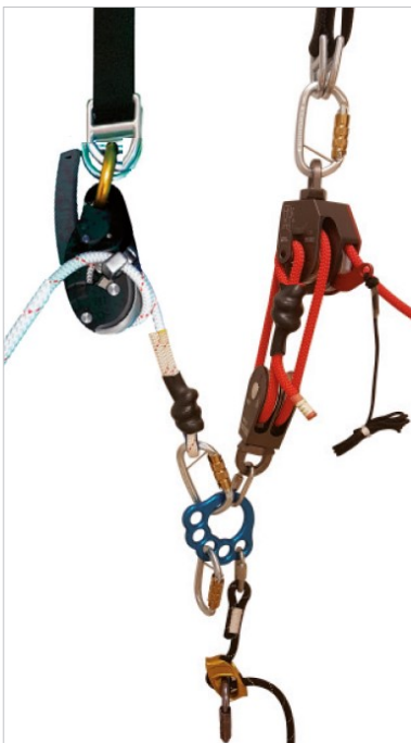
Fig 2 Viser samlet oppsett med taljesett og sikringssats.
