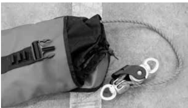
Poulies fixées pour le stockage
